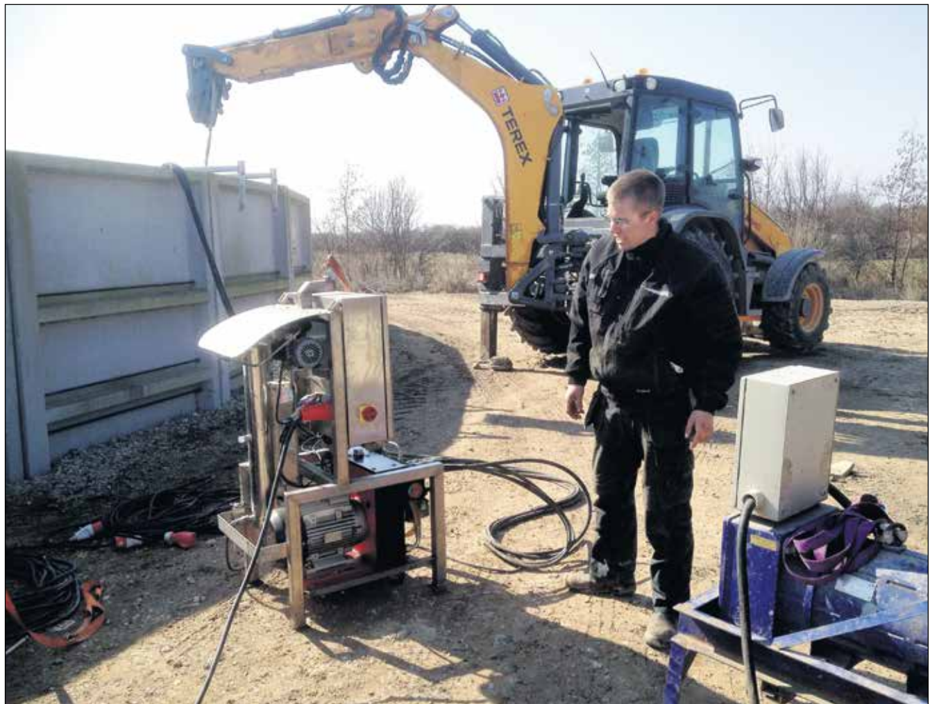
Markmand Jesper Petersen, Skovhave I/S, er ved at ozon- og PowerPack-behandle gyllen i tanken inden udbringning. En cirka halvanden meter lang Power-Pack-stav er ført ned i gyllen via ophænget på rendegraveren. Til venstre i billedet bliver der produceret ozon løbende, som suges ned i tanken via en slange. Til højre i billedet ses den traktorgenerator, som trækker anlægget. (Privatfoto)
